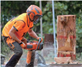
⇐合わせ輪切り競技 傾けた丸太を下側と上側から上下の段差が少なくなるよう伐り出す競技
