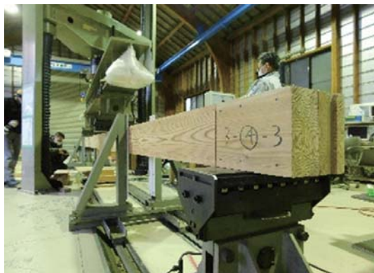
信州カラマツ210材を重ねたNLT材の強度試験
