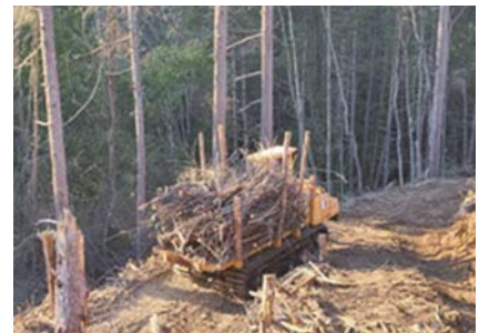
フォワーダによる林地残材の運搬状況
