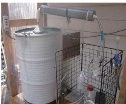
写真1 ドラム缶式精油採取装置
