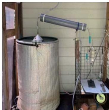
ドラム缶式精油採取装置
