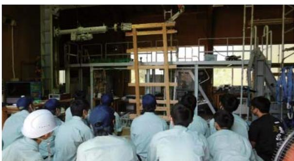
木材部：学生が製作した貫工法壁の強度試験
