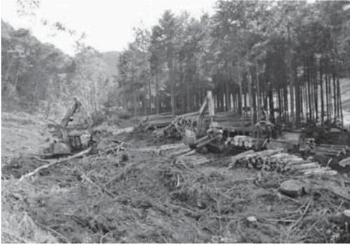
現場ではグラップル(作業道開設、集材・地拵え)、プロセッサ(造材)、フォワーダ(集運材)が定番となっています。
