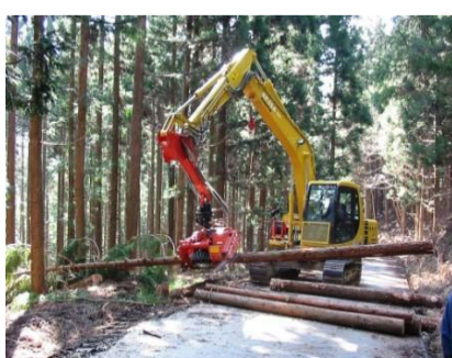
高性能林業機械による作業(伐採・集材・造材等)
