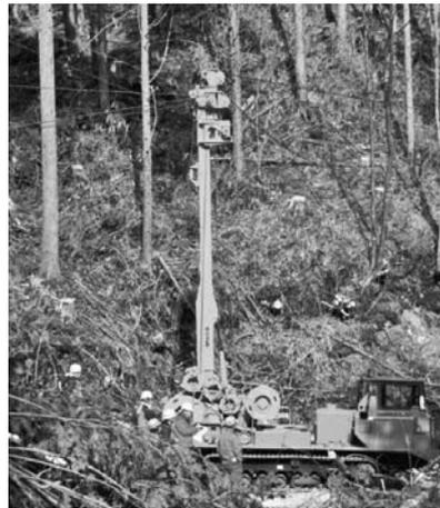
場所から運転ができる有線操作ができること、元柱の作設手間が省けること等が特徴です。従来の機種では、一線あたりの集材範囲を広げて集材量を確保するために、主索直下以外の場所から集材する横取りを、荷掛けフックを人力で運搬して行っていたため、横取り距離が長くなるとワイヤを引っ張っていくのが大変でした。このため、巻きドラムを増設し、横取りを引込索により行うことができるように改良したのが5 胴式タワーヤードです。
