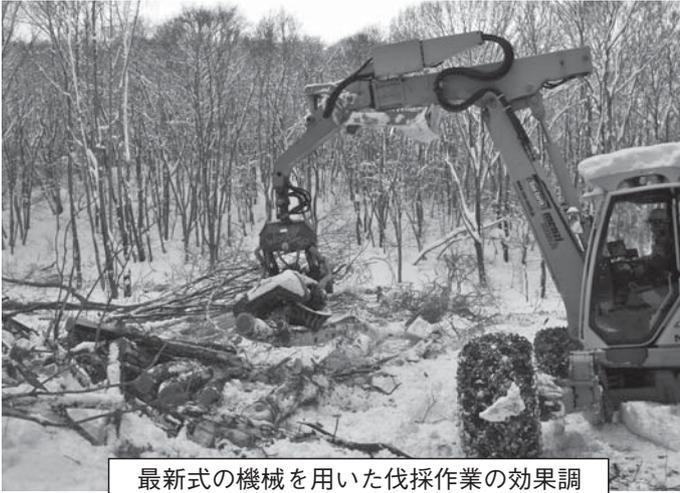
最新式の機械を用いた伐採作業の効果調査。機械の生産効率を調べて、よりよい使い方を提案します
